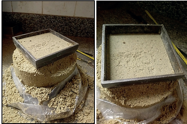
Figura 4 - Moldagem do corpo de prova para o ensaio de cisalhamento direto.
