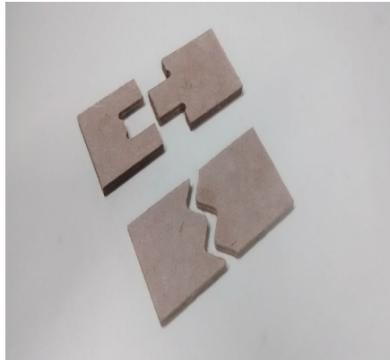
Figura 10: Protótipos de encaixes com passo otimizado, cortados em fresadora CNC.
