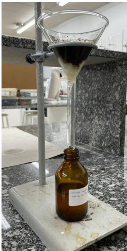
Figura 2 – Obtenção do extrato aquoso de casca de banana
