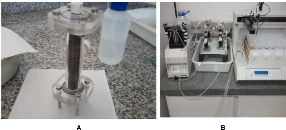
Figura 3. Coluna preenchida com biocarvão (A). Em (B) aparato experimental com bomba peristáltica e coletor de frações.
