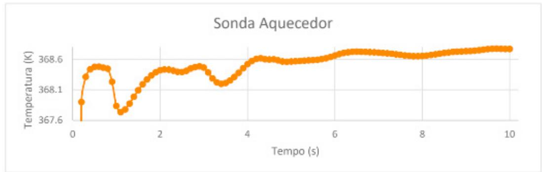
Figura 15 - Variação de temperatura da sonda no aquecedor.
