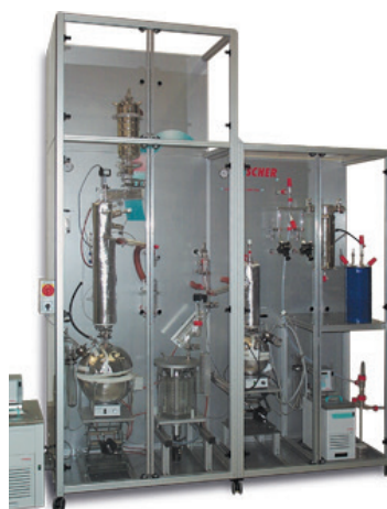
Figura 2. Equipamento para destilação de ponto de ebulição verdadeiro (PEV) i-Fischer® DIST D-2892/5236 MC / FISCHER® AUTODEST® 800/860 MC. Fonte: https://www.htds.fr/en/labo-research/analytical-instruments/physico-chemical-analysis/petrochemical-analyser/laboratory-distillations/distillation-combined-semi-automatic-astm-d2892-d5236/ .
