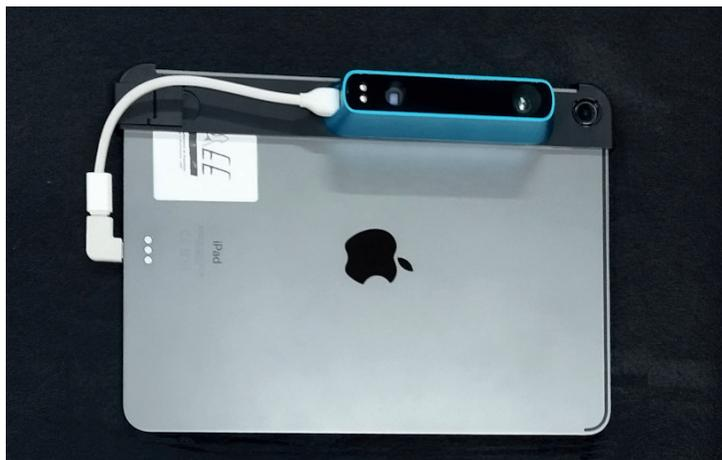
Figura 4 - Scanner acoplado ao Ipad disponibilizado pelo LAEE/UEM
