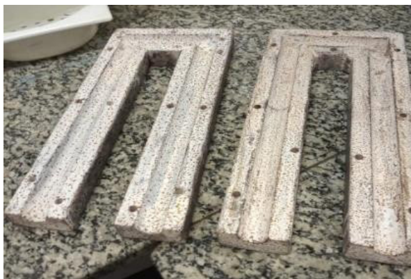
Figura 2 – Molde utilizado no vazamento.
