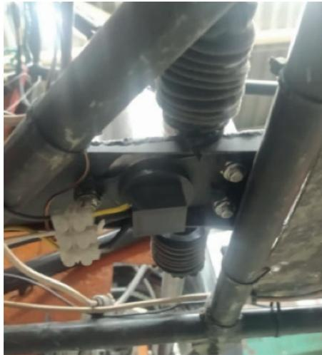
Figura 3. Potenciómetro Acoplado a la Cremallera del Monoplaza de Formula SAE UNIMET
