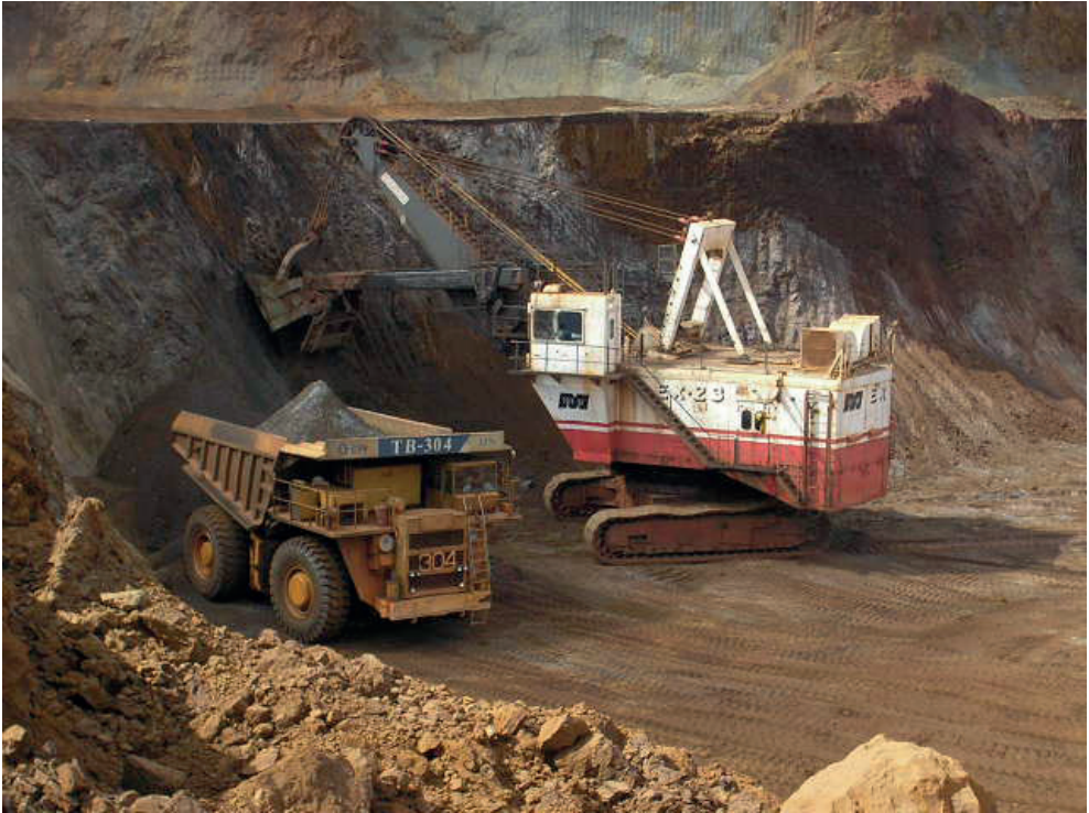
Figura 4.2 - Desmorte realizado por escavadeira hidráulica de forma mecânica.
