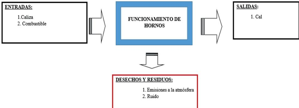
Figura 7. Ficha de Mapeo (Funcionamiento de Hornos)
