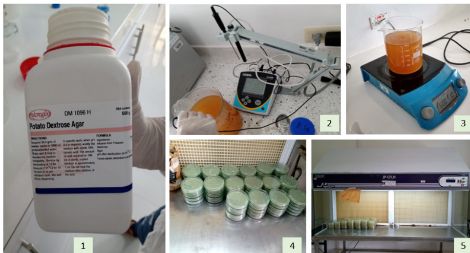
Ilustración 5. 1. Medio nutritivo PDA. 2. Mediciones con pH-metro. 3. Plancha de agitación. 3. Cajas Petri con medio nutritivo. 5. Cabina de flujo laminar.
