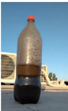
Figura 3. Recipiente usado para producir biogás
