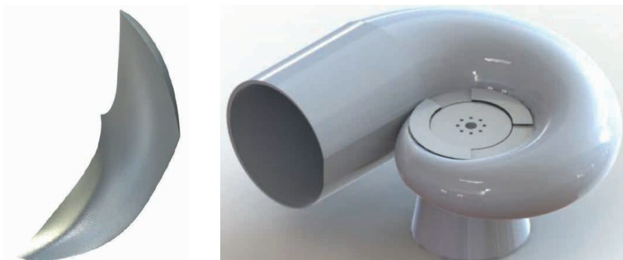
Figura 11 – a) Modelagem da Pá, b) Modelagem da Turbina Francis
