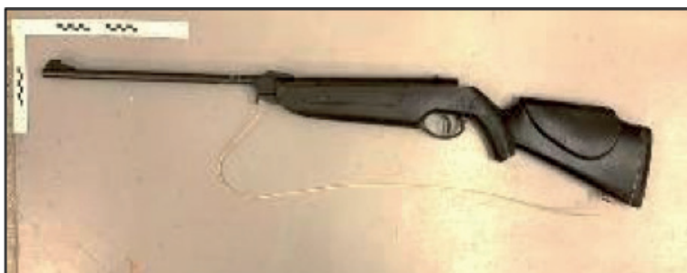
Figura 1: Carabina de pressão, adaptada para calibre nominal .22 L.R, encaminhada pela Delegacia de Polícia (Arma A)
