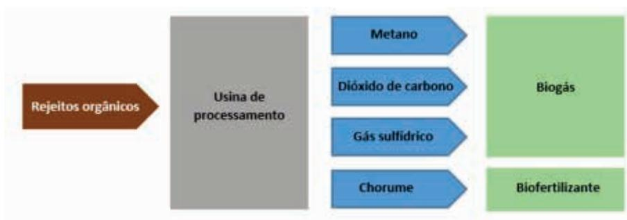
Fig. 1 – Representação esquemática do funcionamento do biodigestor
