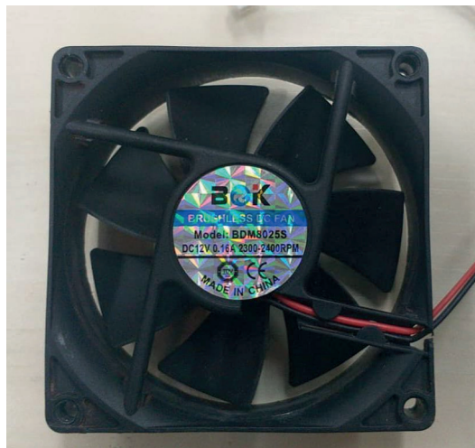
Figura 3: Cooler/ventoinha utilizada como resistor.
