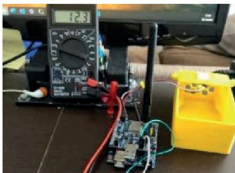
Figura 20 – Corrente consumida pelo dispositivo *IoT*
