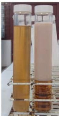
Figura 3: Mistura de óleo de canola com NaOH.
