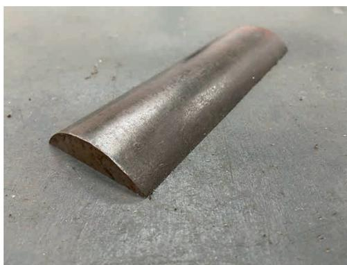
Figura 1: Amostra de aço SAE 1045.
