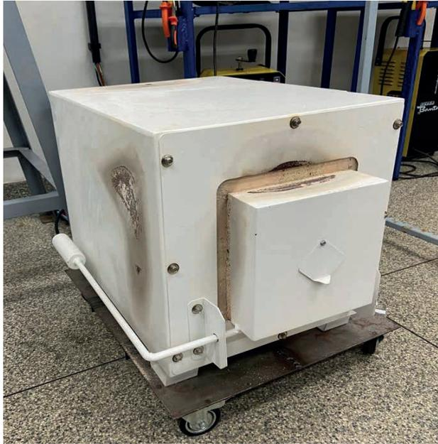
Figura 3: Forno mufla aplicado aos ensaios.
