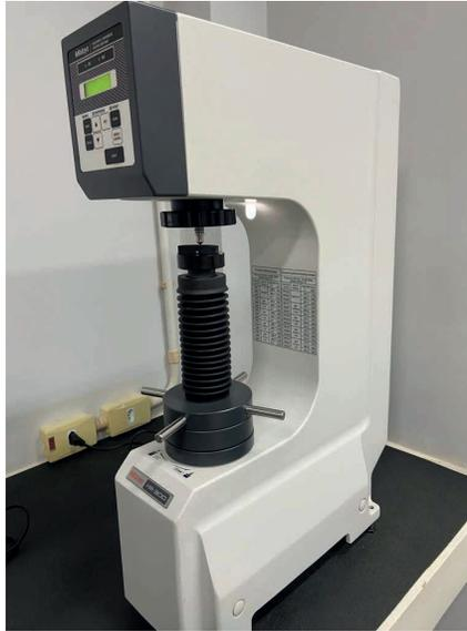
Figura 5: Equipamento de medição de dureza com durômetro HR-300.
