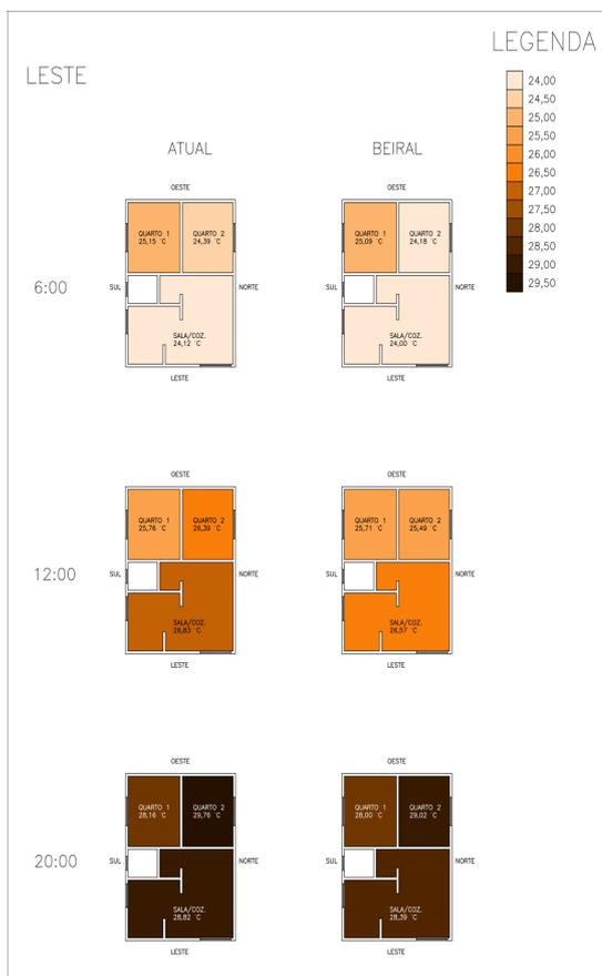
Figura 17 – Temperaturas internas simuladas na HIS com a fachada principal orientada a Leste
