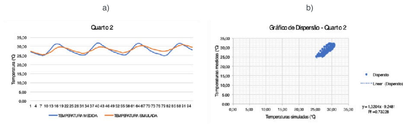
Figura 8 – a) Relação entre temperatura simulada e temperatura medida e b) Gráfico de dispersão do quarto 2
