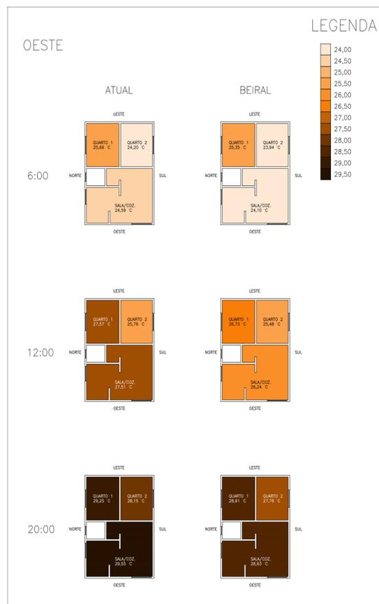
Figura 18 – Temperaturas internas simuladas na HIS com a fachada principal orientada a Oeste
