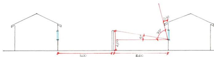
Figura 3 – Corte esquemático da situação real
