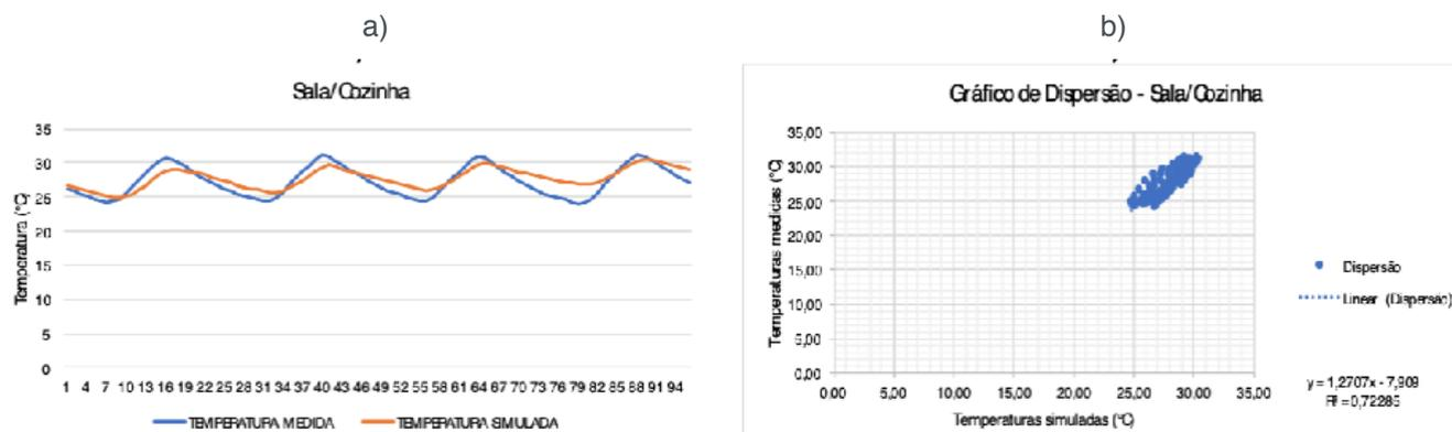
Figura 9 – a) Relação entre temperatura simulada e temperatura medida e b) Gráfico de dispersão da sala/cozinha
