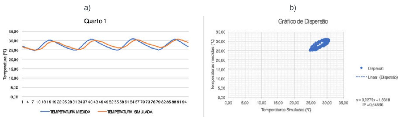
Figura 7 – a) Relação entre temperatura simulada e temperatura medida e b) Gráfico de dispersão do quarto 1
