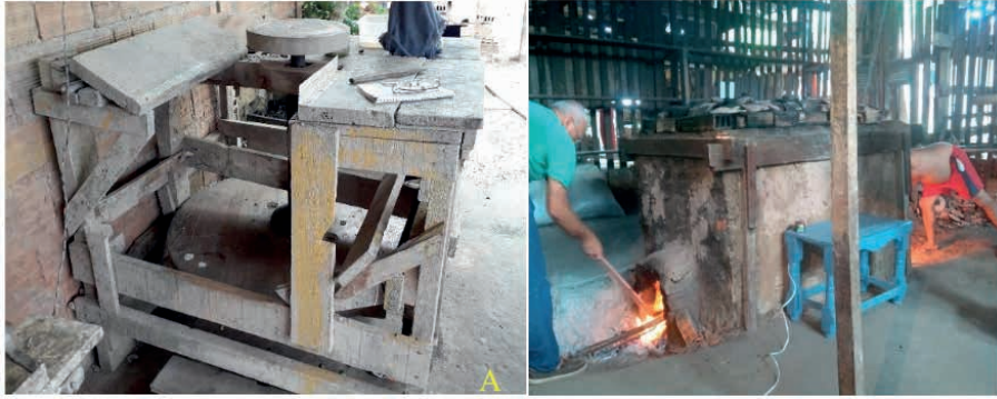
Figura 2. A) Torno de madeira em Fazendinha, Município de Bragança, PA; B) Forno tipo caieira na Olaria do Espanhol, Icoaraci, Belém, PA.
