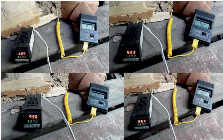
Figura 5. Variação da temperatura no mesmo forno. O Controlador com marcador digital vermelho monitora a parte central do forno e o controlador de cabo amarelo monitora o canto.
