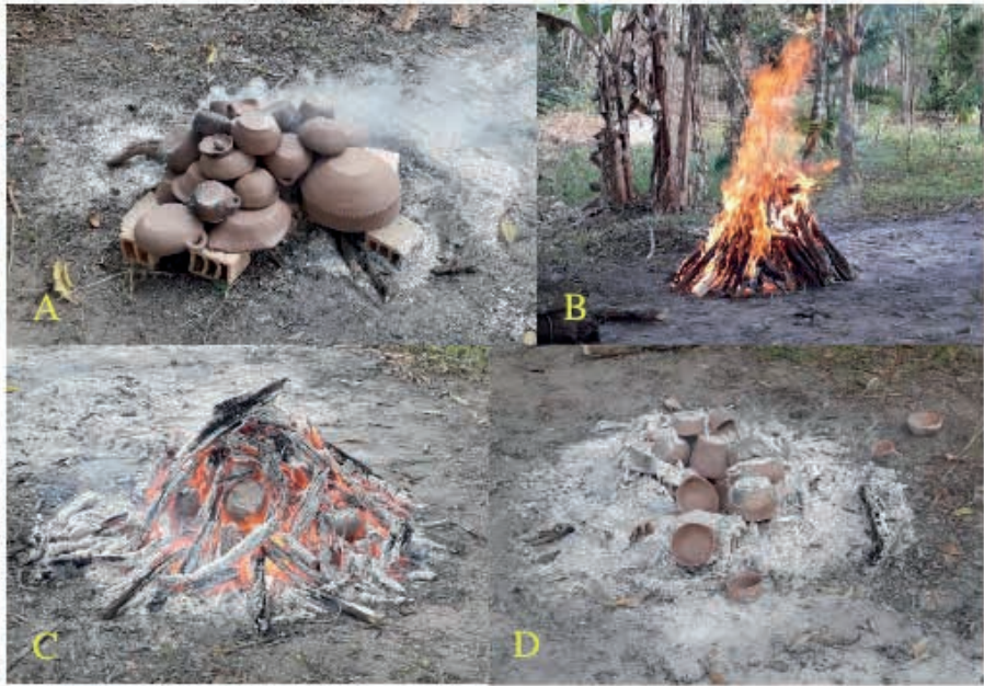
Figura 1. Cozimento de cerâmica por coivara, ou a “céu aberto”, na Vila Quiera, em Bragança, PA. A) Empilhamento das peças; B) Cozimento com lenha sobrepostas as peças; C) Finalização do cozimento; D) Retirada das peças ainda quentes.
