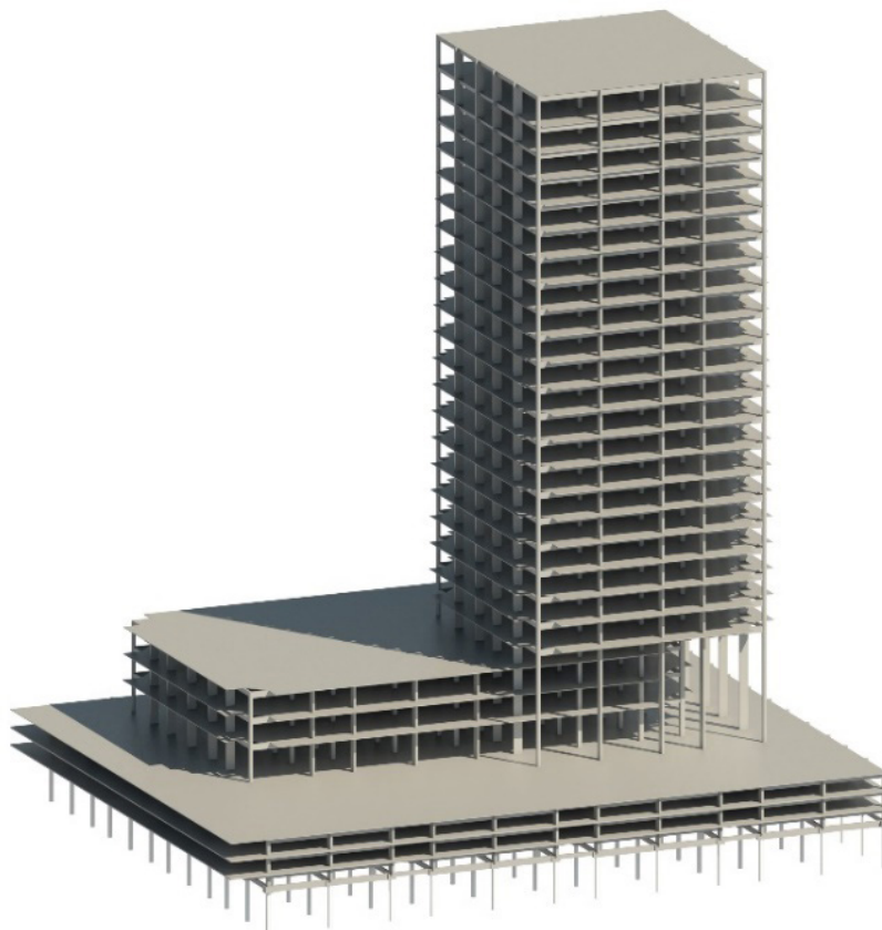
Figura 5: Configuração da estrutura com fachadas retas.
