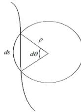
Figura 4. Diferencial de arco y radio de curvatura
