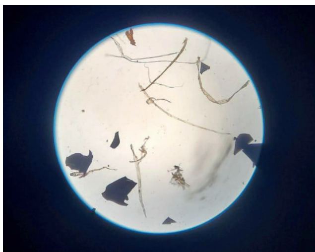
Figura 6 - Fibras de tecido encontradas no resíduo pirolizado do tecido 80% algodão/20% poliéster
