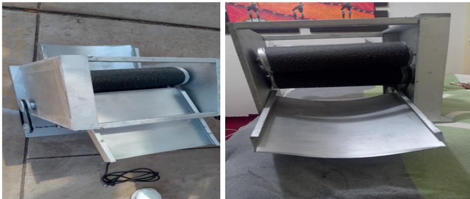
Figura 9 - Prototipo de Maquina peladora de habas.
