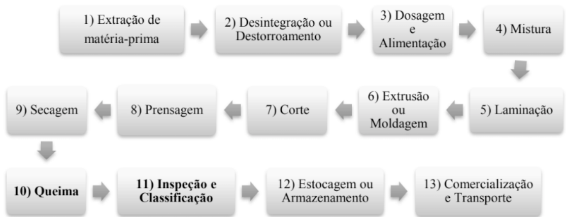
Figura 1- Fluxograma do processo de produção da indústria de cerâmica vermelha
