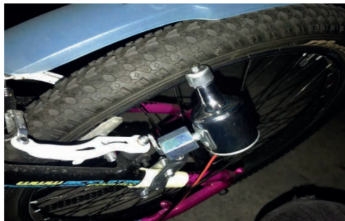
Figura. 1 muestra la colocación del Dinamo en la llanta trasera marca AXA Aluminium Right Dynamo
