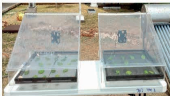
Imagen 1 Secador solar tipo gabinete
