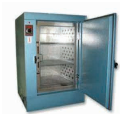
Imagen 2 Secador convencional con calentamiento eléctrico no convectivo
