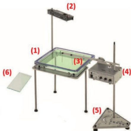
Figura 4: Montagem do experimento 3 (refração de uma onda bidimensional) - Elementos do conjunto: (1) Cubo de ondas; (2) Iluminador de luz fria e estroboscópio; (3) Ponteira geratriz plana; (4) Gerador de abalos; (5) Conjunto suporte com tripé e haste; (6) Placa de vidro. (Fonte: estúdios Cidepe Digital)
