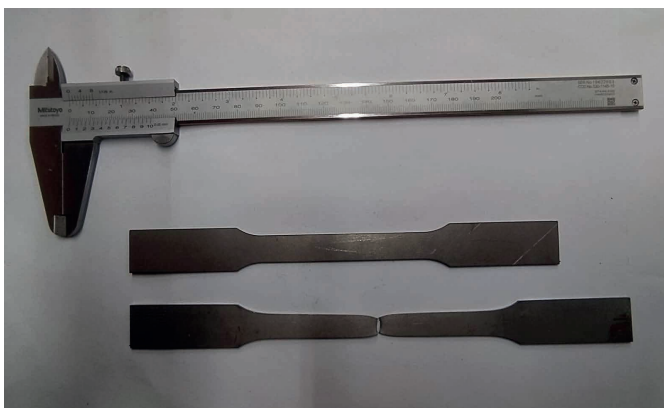
Figura 6: Comparativo dimensional dos corpos de prova antes e depois do ensaio.
