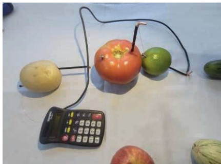
Figura 2: Alimentos ligados em série fornecendo energia para uma calculadora
