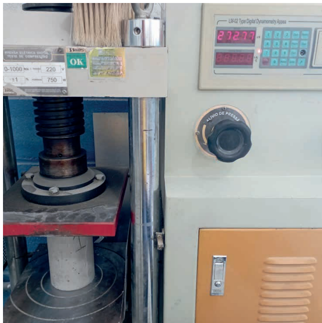
Figura 6 – Rompimento do corpo de prova
