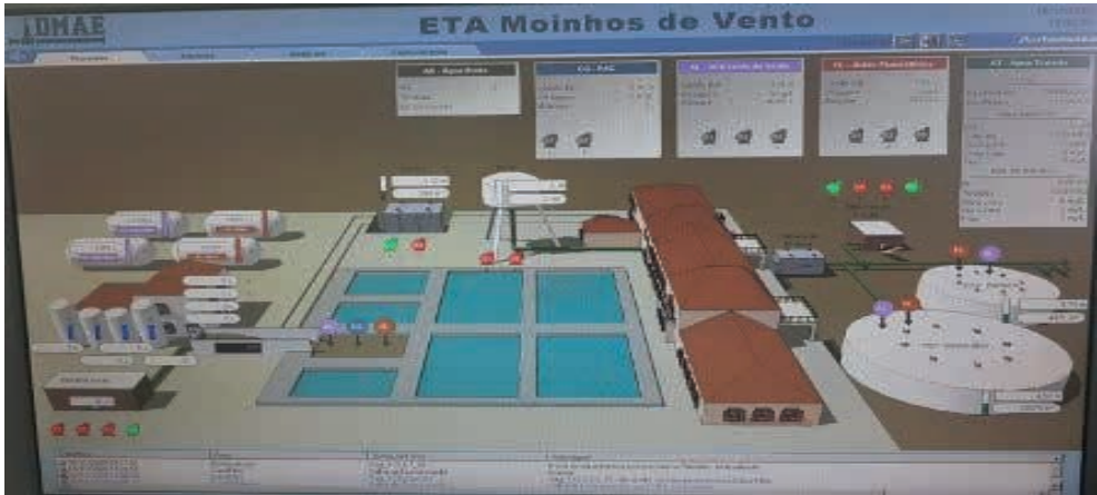
Figura 10: Supervisório da Estação de Tratamento de Água Moinhos de Vento.
