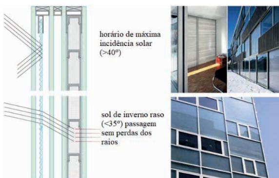
**Figura 9** – Aplicação de PCM em vidros
