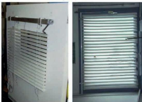
**Figura 8** – Modelo de persianas com incorporação de PCM
