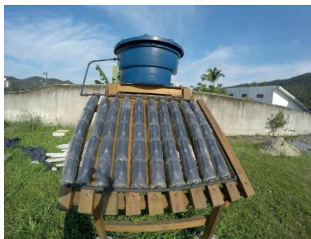
Figura 01: Aquecedor Solar construído com materiais recicláveis confeccionado pelos bolsistas do projeto Aquecedor Solar
