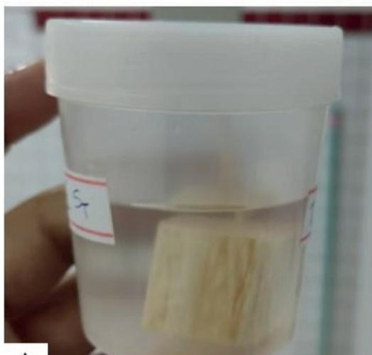
Figura 3. Corpo de prova utilizado para realização dos cortes anatômicos embebidos em glicerina 50%.
