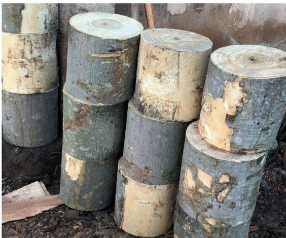
Figura 2. Divisões do caule de paricá, toras com 30 cm de DAP e 30 cm de altura, utilizadas para extração de corpos de prova dos cortes anatômicos.
