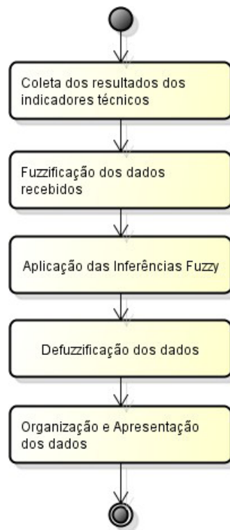
Figura 5 – Etapas do processo de aplicação do Controle da Lógica Fuzzy
