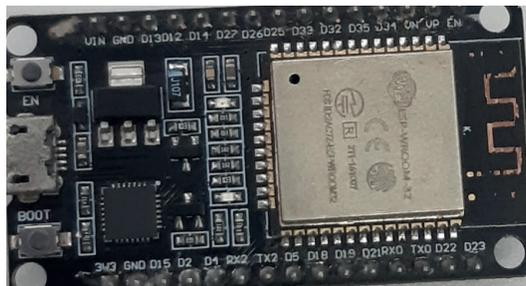
Figura 2. Antena PCB do Esp32.
