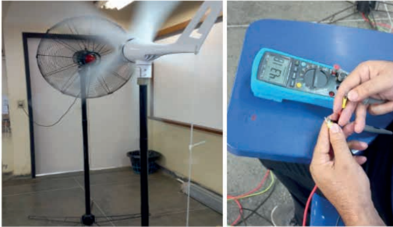
Figura 6. Tensão gerada pelo aerogerador quando v=3\text{m/s} .
