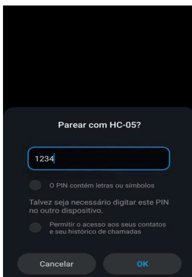
Figura 9. Pareamento do aplicativo com o módulo HC-05;
