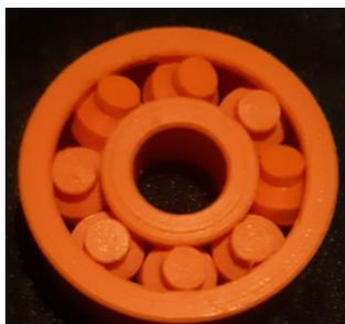
Figura 8: Protótipo de rolamento para o setor naval. Fonte: O Autor
