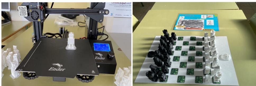
Diseño de un peón blanco robotizado por parte del alumnado y Juego de piezas de Ajedrez tras su diseño en impresión 3D.
