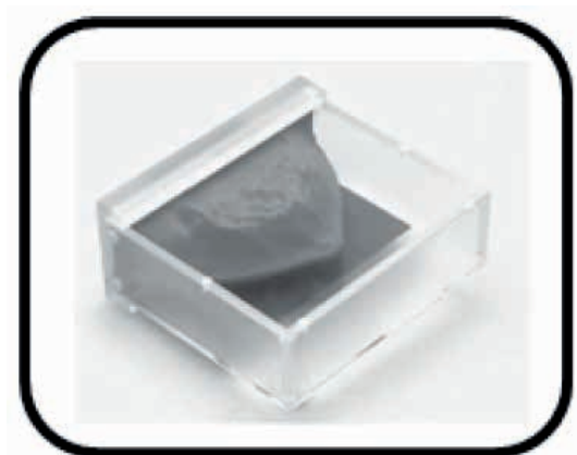
Figura 1: Simulador antropomórfico de mama Nuclear Associates modelo 18-226 (Rachel).
