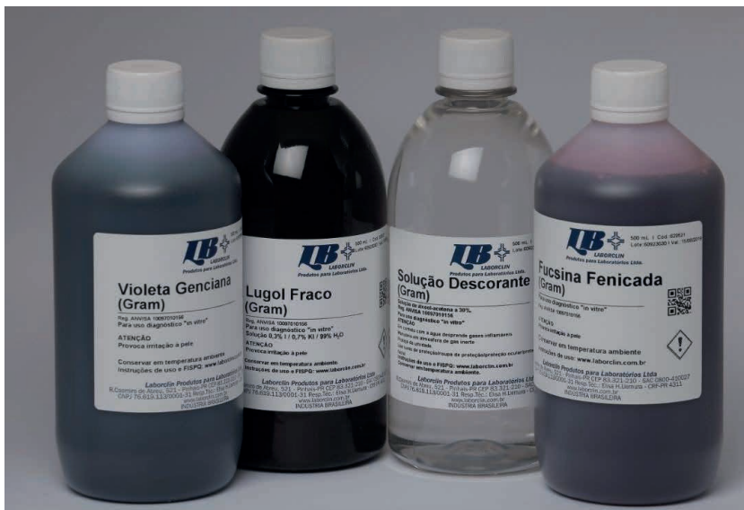
Figura 3: Kit de corantes utilizados na coloração de Gram. Da esquerda para a direita: Violeta Genciana, Lugol, Solução descorante e Fucsina.
