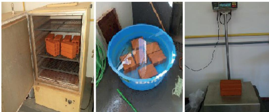
Figura 4: Realização do ensaio de absorção de água. Fonte: Autor do Trabalho.
