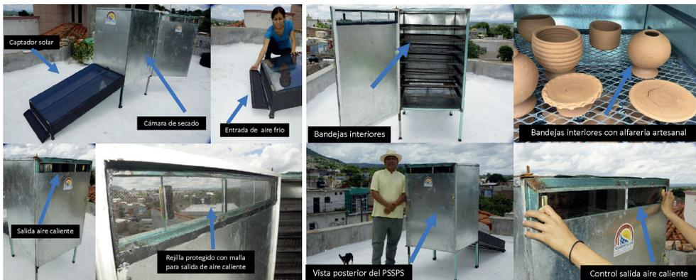
Figura 4.- Dimensionamiento del PSSPS.
