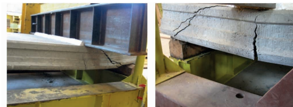
Figura 5 – Ruptura por flexo-cortante de uma laje alveolar, Santos (2014).
