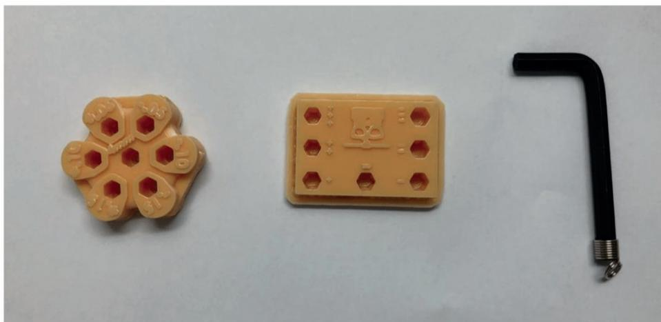
Figura 19: Peças impressas para calibragem da impressora (placa e hexágono) e chave allen 4mm para regulamentação.
