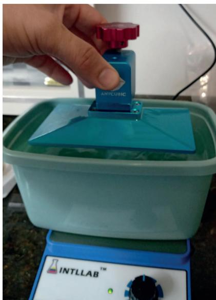
Figura 46: peça imersida no álcool isopropílico agitado por um agitador magnético para a remoção de resina supérflua.
