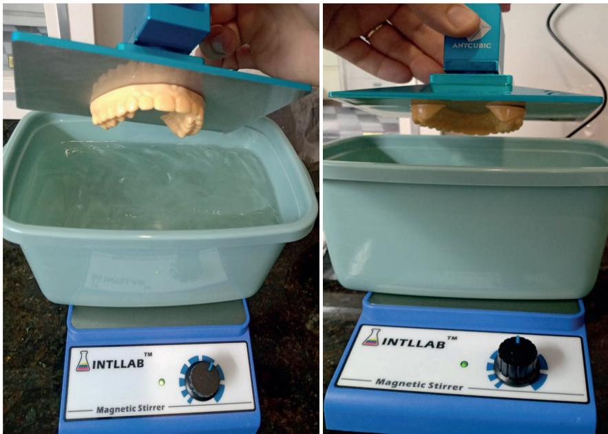
Figura 45: Imersão da peça em álcool isopropílico.
