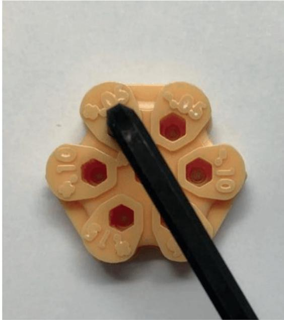
Figura 22: Hexágono do teste de calibração da impressão no ponto “+0,5”, o qual é aceitável, entrar frouxo.
