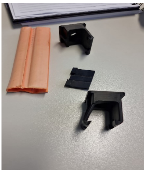
Figura 12 – Peça fraturada, impressa na horizontal.
