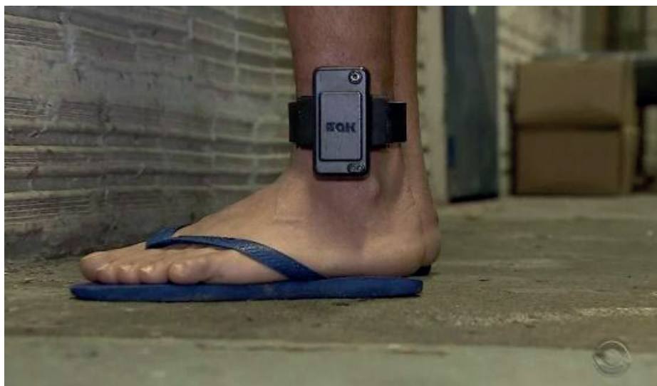
Figura 1 – Tornazeleira eletrônica utilizada no monitoramento de um apenado. Fonte: (Reprodução) RBS-TV 1 .
